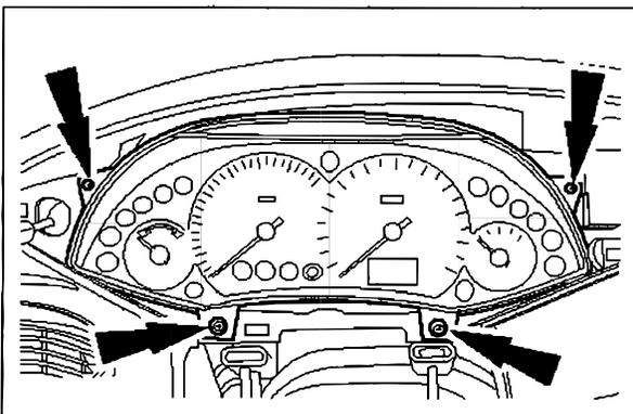
3. Schrauben - Kombiinstrument herausdrehen.
