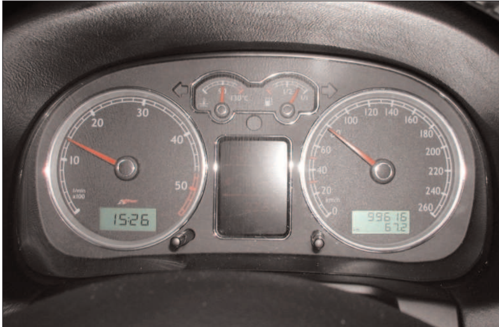
8. fertig sieht das ganze dann so aus. Kombination von original SE Tachoringen und Phaeton -Zeigern
